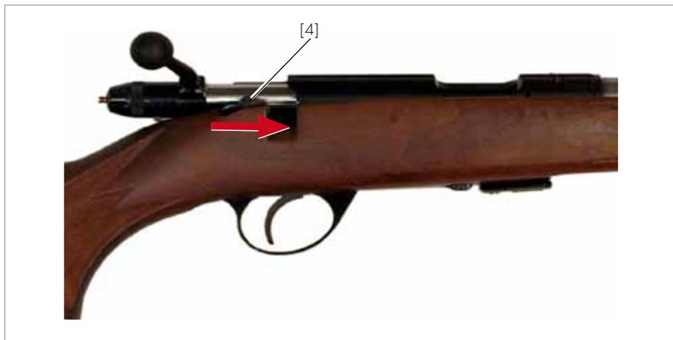
Fig. 10 Desplazar hacia delante la palanca de seguridad (quitar el seguro)
