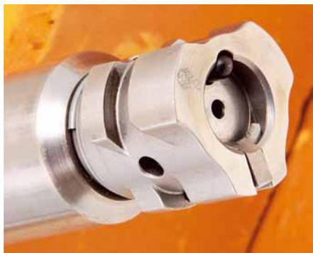
L'otturatore è dimensionato ad hoc per il calibro. La chiusura è assicurata da sei alette frontali, in due serie di tre a 120 gradi.
