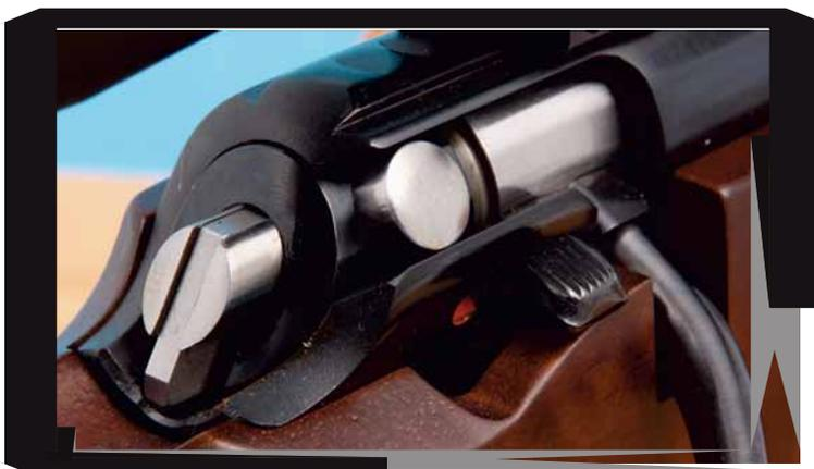
Quando l'arma è pronta al fuoco, la coda del percussore sporge dall'estremità posteriore dell'azione. In evidenza anche la camma di armamento e la sicura manuale a due posizioni, che non blocca l'otturatore.
